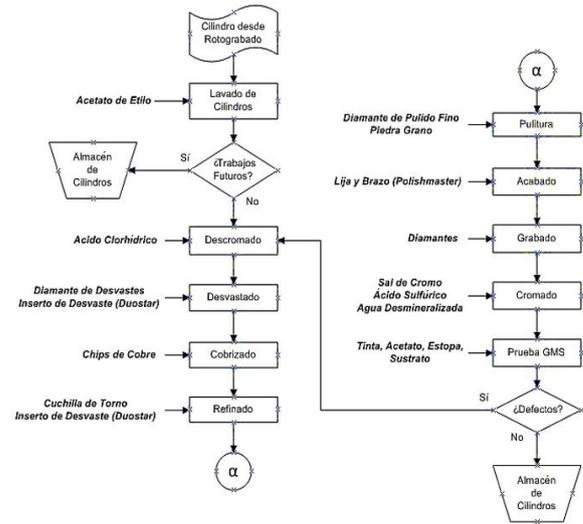
Figura 4. Flujograma de proceso del área de cilindros.
