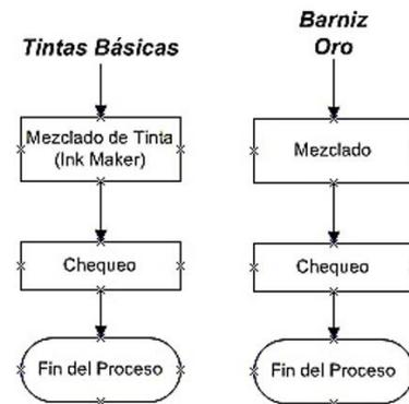
Figura 5. Flujograma de proceso del área de tintas.
