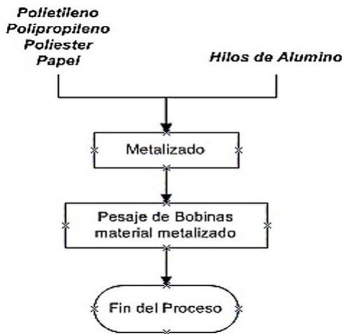
Figura 7. Flujograma de proceso del área de metalizado.
