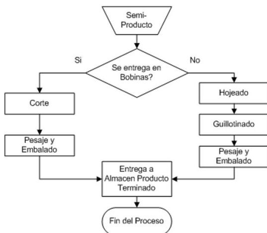
Figura 9. Flujograma del Proceso de Corte y Acabado.
