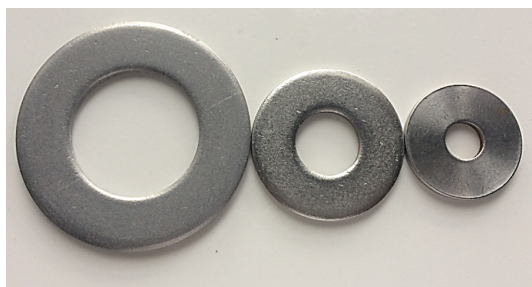
Figura 5. Material moliente – Arandelas de acero inoxidable
